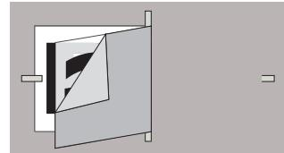
Retirez le backing\* en tirant doucement et horizontalement.
